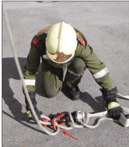
Halben Schlag durch den Bügel des Hohlstrahlrohres stecken und über das Mundstück legen
